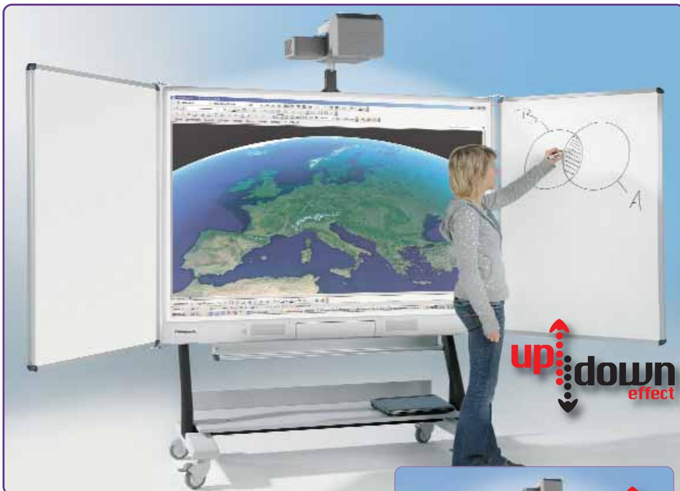
**Federzugsysteme** sind ebenfalls ausgereifte Höhenverstellungssysteme, die gegenüber der Pylone einige Vorteile haben – gerade, wenn sie in Verbindung mit interaktiven Tafelsystemen eingesetzt werden.
